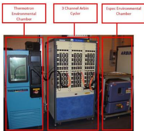
圖9. Arbin BT2000循環儀、Espec及Thermotron環境測試箱
