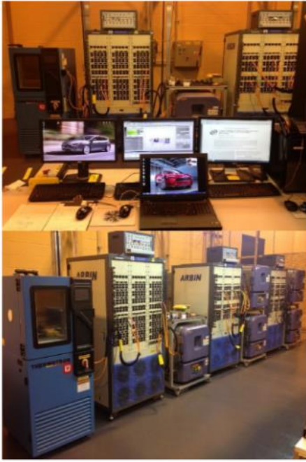
圖10. 實驗設置，包含循環儀、環境測試箱、資料擷取系統
